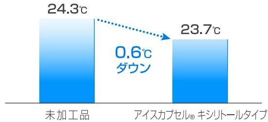
試験法：温度34℃/XRH30%雰囲気中にて水滴0.5mlを生地に含浸。
